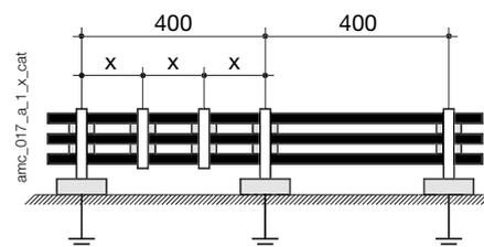
Гибкие шины должны монтироваться на изолированные держатели с максимальным расстоянием 400 мм. Сами шины должны связываться друг с другом манжетами, как показано на диаграмме. Расстояние между манжетами зависит от электродинамических ограничений в случае короткого замыкания. В таблице приведены рекомендованные расстояния между манжетами.
